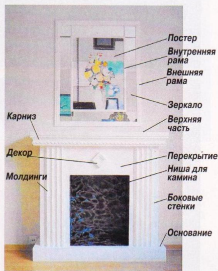
Составные части камина. Такой портал из пеноблоков можно довольно быстро сделать своими руками.
