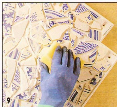
9 Чтобы затирка не забила крепёжные отверстия, вставляют в них шурупы. Соблюдая осторожность (чтобы не пораниться об острые края черепков), аккуратно заполняют затиркой швы между черепками.
